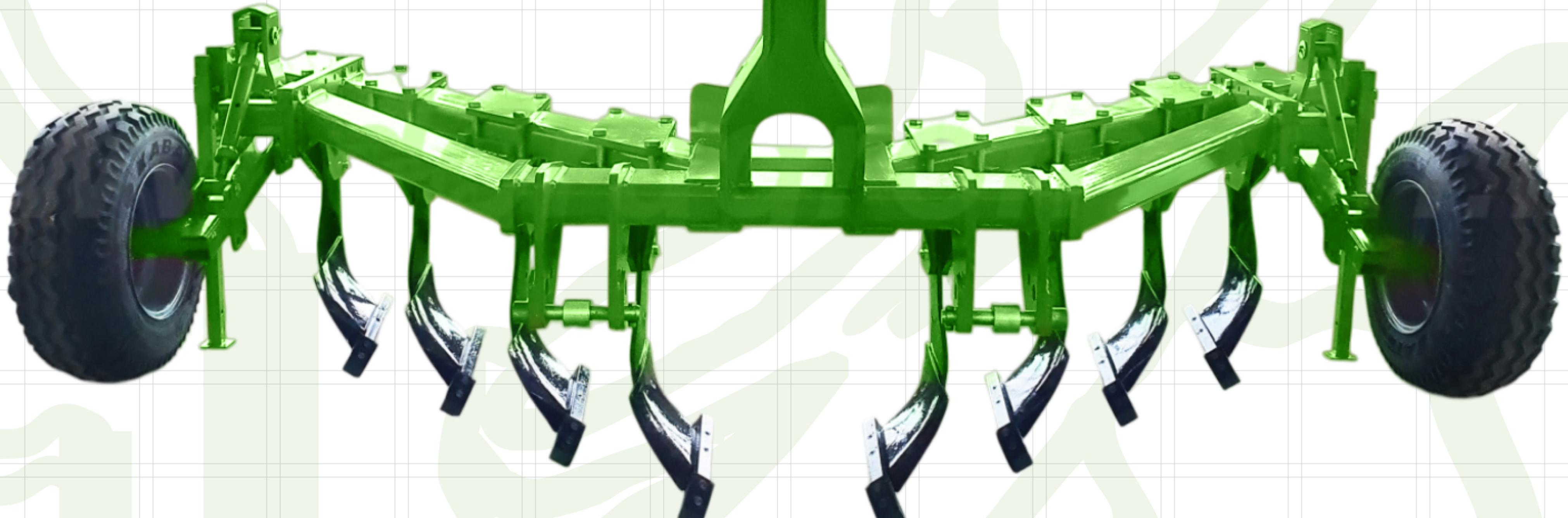
Агрегат оснащён стойками «параплау», которые во время работы глубокорыхлителя, практически не повреждают верхний слой почвы и не создают комковатостей на поверхности поля.
